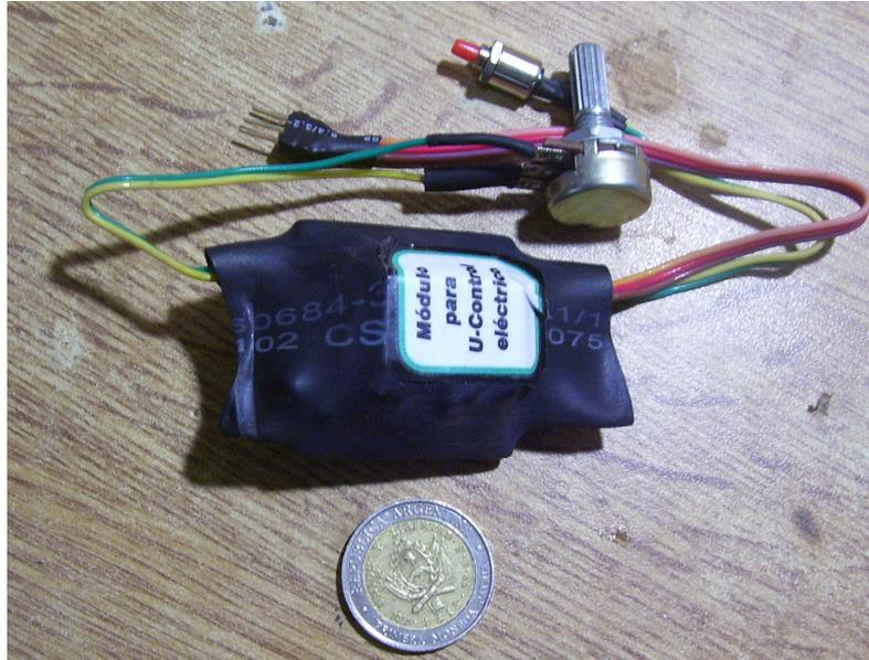
**Una vez conectado se regula el tiempo de vuelo deseado, que puede ser entre 1.5 minutos y 7 minutos (se puede modificar para valores mayores), y pulsando el botón de start, el motor comenzará a girar al máximo de RPM por el tiempo determinado.**
